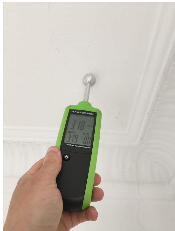
Fugtniveau i soveværelsesloft mod ydervæg
